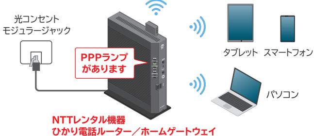
※正しく接続されていると、ホームゲートウェイ本体のランプが以下の通り点灯します。
